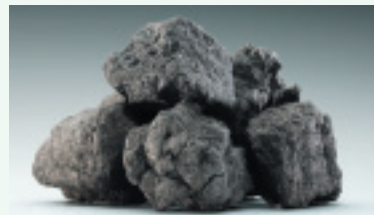
コークス コークスとは、石炭を蒸し焼きにできる、高純度の炭素の塊で、鉄鉱石から鉄を取り出すための還元材および熱源として使用します。
