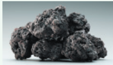
焼結鉱 粉状の鉄鉱石と石灰石を約1,300℃の高温で焼き固めて、5～25mm程度の均一の塊にします。
