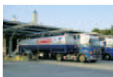
LNG tank lorries
